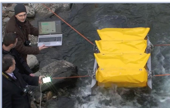
Fig. 10.24 Teste funcționale pe apă (Bogorin-Predescu, Țițu, & Țițu, Data acquisition system for a hydroelectric turbine with deformable blades, 2024)
